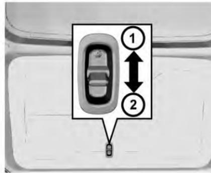
Si está equipado, el vehículo se puede abrir desde el Compartimiento de equipaje interior por el interruptor de bloqueo que le permite bloquear o desbloquear el compartimiento de equipaje.
