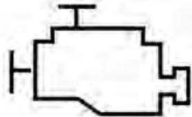
La luz indicadora se ilumina cuando la ignición está encendida pero el motor no ha arrancado. Esto indica que el foco de la luz del indicador está funcionando normalmente.
