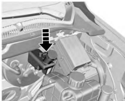
Antes de abrir la tapa de relleno, limpie el área alrededor de la tapa de relleno del depósito de líquido de frenos/embrague.
