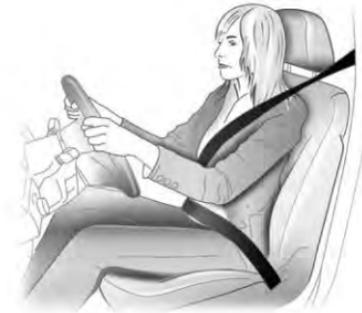
El cinturón de seguridad está diseñado para uso por un solo pasajero. Debido a las restricciones del cinturón de seguridad, un pasajero menor de 12 años o de menos de 150 cm de altura no debe sentarse en el asiento del pasajero
