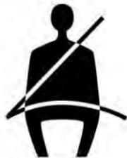
La luz de advertencia del cinturón de seguridad se ilumina si el conductor no se abrocha adecuadamente el cinturón de seguridad después de que se enciende la ignición.
