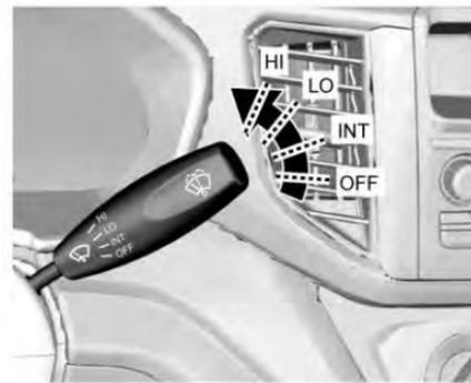
Para usar el limpiaparabrisas delantero, encienda primero la ignición y luego empuje la palanca de control del limpiaparabrisas/lavaparabrisas. El limpiaparabrisas delantero tiene las siguientes cuatro posiciones de operación:
