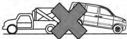
Al remolcar el vehículo con un remolque de plataforma, apague la ignición y verifique que el vehículo esté firmemente sujeto al remolque. Si debe remolcar al vehículo desde la parte trasera, utilice un dispositivo de remolque que soporte las ruedas delanteras. Las ruedas delanteras no deben estar en el suelo cuando el vehículo es remolcado desde la parte trasera. De lo contrario, puede causar graves daños a la transmisión del vehículo.
