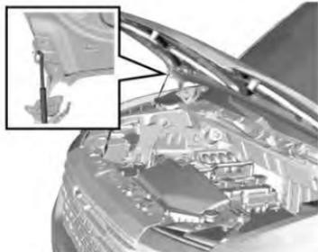
3. Separe la varilla de soporte del cofre de la abrazadera de fijación. Conecte el extremo libre de la varilla de soporte en la ranura.
