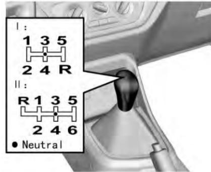
Cambie las velocidades de acuerdo con el patrón en la palanca de cambios después de que se suelte el embrague. Si tiene que cambiar a R (Reversa), primero detenga el vehículo, presione completamente el pedal del embrague y luego cambie de Neutral a R (Reversa).
