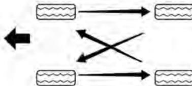
Las llantas delanteras y las llantas traseras tienen diferentes funciones y, por lo tanto, tienen diferentes niveles de desgaste. Las llantas delanteras se desgastan más rápido que las llantas traseras. Para prolongar la vida útil de la llanta y evitar un desgaste desigual de la banda de rodamiento:
