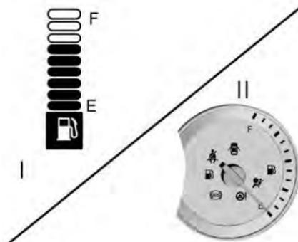
El indicador de combustible muestra el nivel de combustible en el tanque de combustible.
