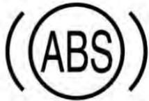
La luz de advertencia del ABS se encenderá inmediatamente cuando se encienda la ignición. Indica que el sistema está realizando una inspección automática y que el foco de la luz de advertencia está funcionando normalmente. La luz de advertencia se apaga varios segundos después.
