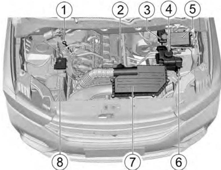
1. Varilla de medición del aceite del motor
