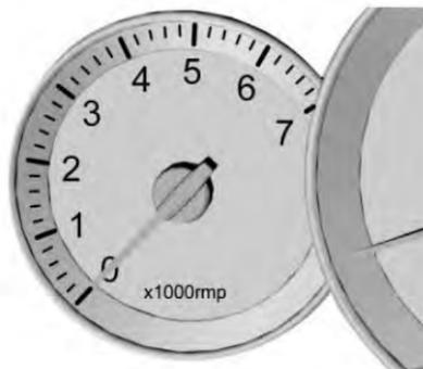
El tacómetro muestra las revoluciones del cigüeñal del motor por minuto.
