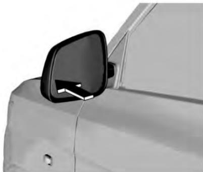
Para ajustar el espejo retrovisor exterior, presione el borde del espejo a mano a un ángulo de vista apropiado.
