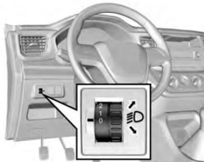
La perilla de nivelación del faro está en el lado izquierdo del tablero de instrumentos.
