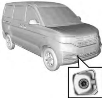
Hay una cubierta de orificio en el lado derecho de la defensa delantera del vehículo. Ábrala para tener acceso al orificio de fijación para la instalación del gancho.
