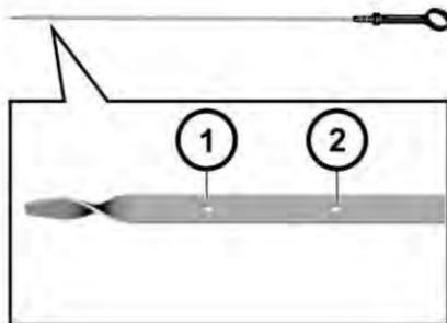
7. Observe el nivel de aceite en la varilla de medición de aceite. El nivel de aceite debe estar entre el límite inferior (1) y el límite superior (2).
