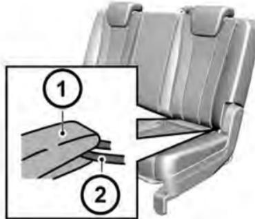
4. Conecte el calibrador de fijación (1) en el asiento de seguridad para niños al dispositivo de fijación en el vehículo (2). Opere de acuerdo con las instrucciones del asiento de seguridad para niños.
