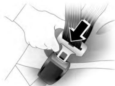
2. Coloque la placa de seguro en la hebilla para asegurar el cinturón. Jale el cinturón del hombro para ajustar la tensión del cinturón de la cadera.
